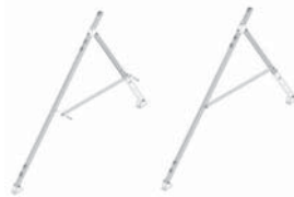
Obr. 35 Namontujte vzpěry rámu.
